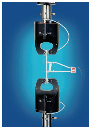
figure 3.20 - Eprouvette entre pinces avec un extensomètre à couteau attaché (photo de Courtesy of MTS Systems Corporation)
