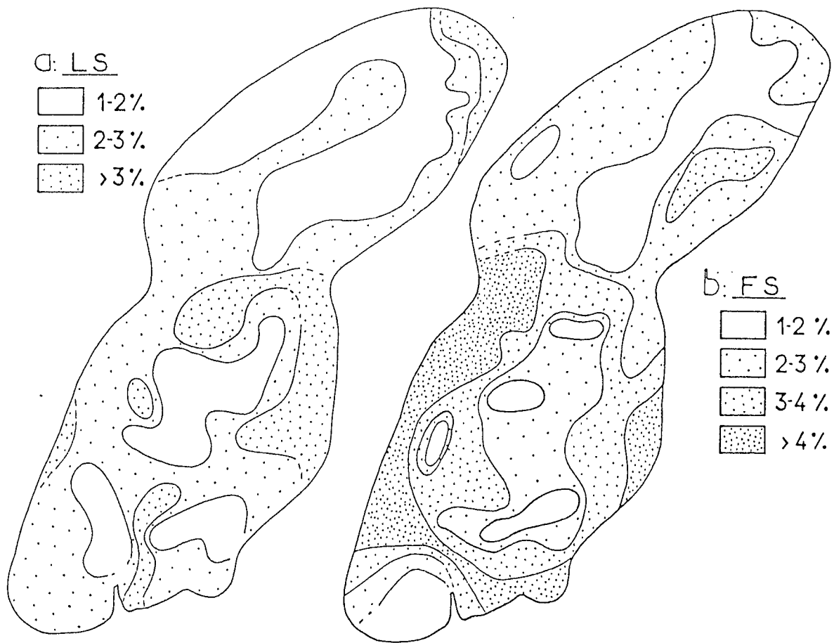
Fig.IV.13-Carte d'iso-intensité des paramètres LS\% = [(K_{max}/K_{int}) - 1] * 100 et FS\% = [(K_{int}/K_{min}) - 1] * 100 de l'anisotropie de la susceptibilité magnétique. a: carte de LS\% ; b: carte de FS\% .
