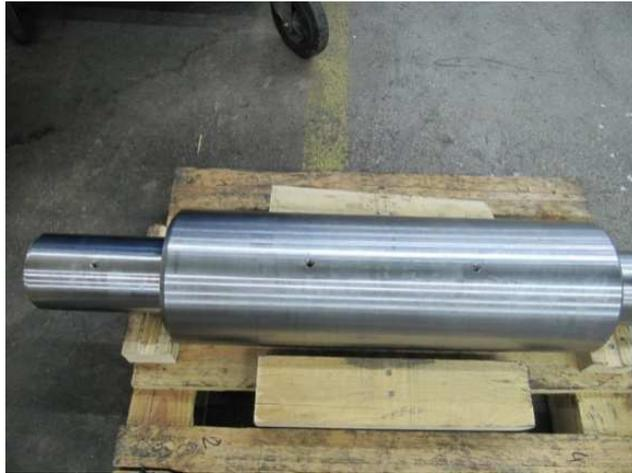
Figure 72 : Fixations pour les sondes de température
