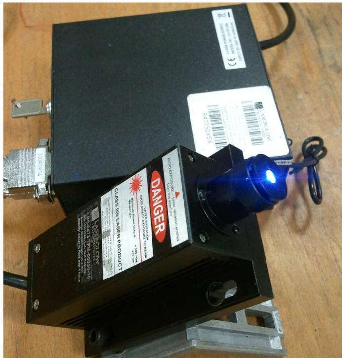
Figure 85: Laser Système Bleu 473 nm de Laserglow Technologies
