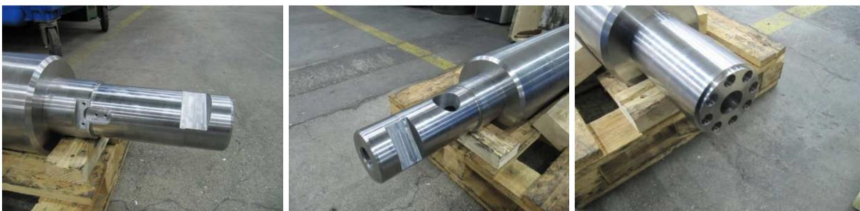
Figure 71 : Extrémités du fourreau à la fin d'usinage
