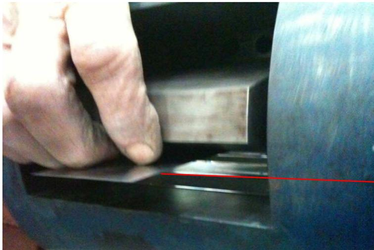
La languette en acier souple permet de tenir les joints dans leurs emplacements sur le socle
