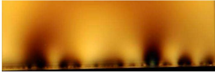
Figure 69 : Points de concentration de contrainte au contact surface verre – acier électro-érodée optimisée avec intercalage de clinquant d'épaisseur 100 µm
