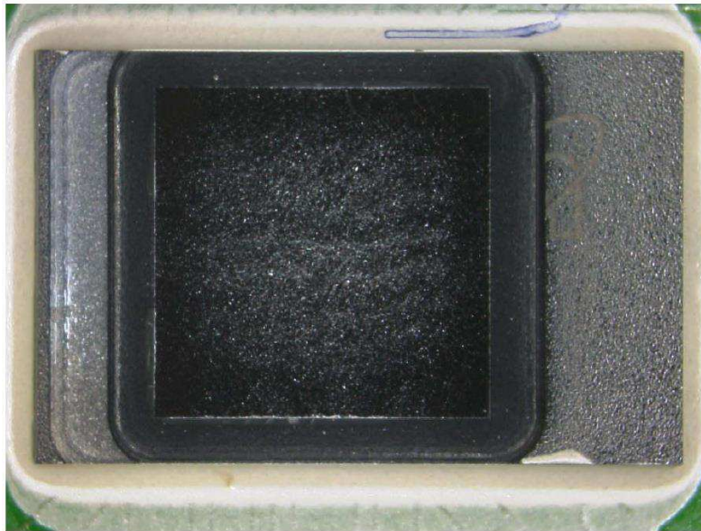
Figure 42 : Ouverture d'une DDR2 pour amincissement [HIR13].
