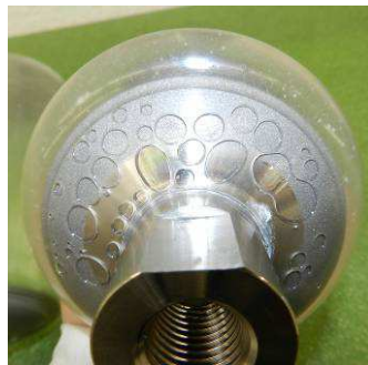
Figure 172 : Cavitations sur l'embase
