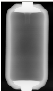
Figure 175 : Radios aux rayons X d'un liner époxy bobiné
