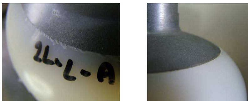
Figure 178 : Recul de la matière à l'interface PEA6 / embase provoqué par le retrait
