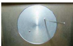
Figure 133 : Thermocouples intégrés à l'intérieur du moule (gauche) température matière, (droite) température air interne
