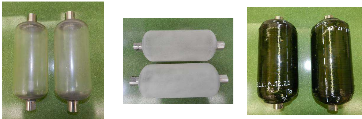
Figure 174 : Liners époxy rotomoulés, sablés puis bobinés
