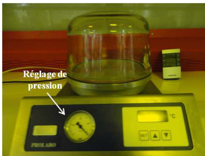
FIGURE 2.30 – Enceinte à vide utilisée dans le procédé de préparation du PDMS.
