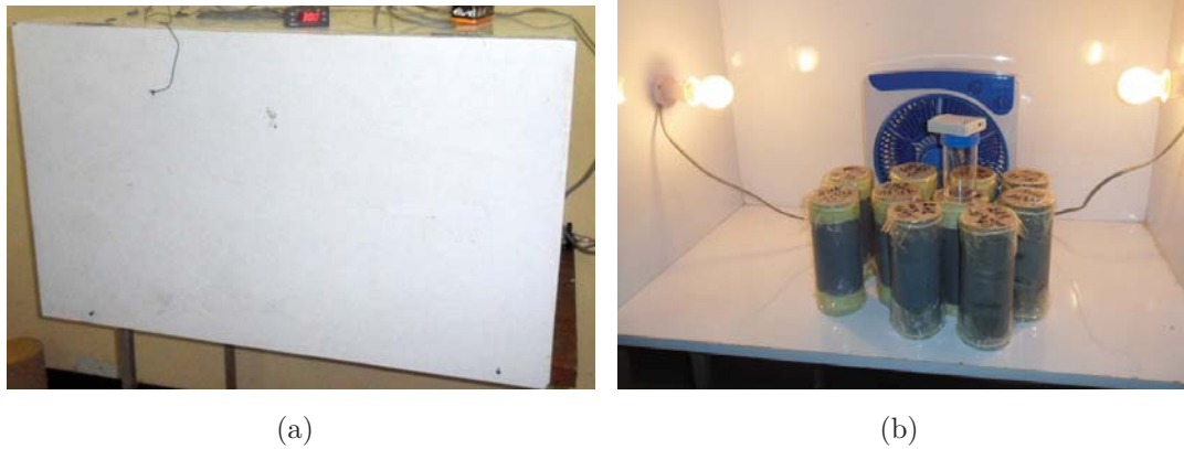
Fig. 3.6 – Enceinte régulée en température contenant les colonnes de sol : (a) enceinte fermée (b) enceinte ouverte
