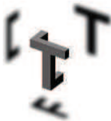
FIGURE 1.2 – Plusieurs projections sont nécessaires pour reconstruire l'objet.
