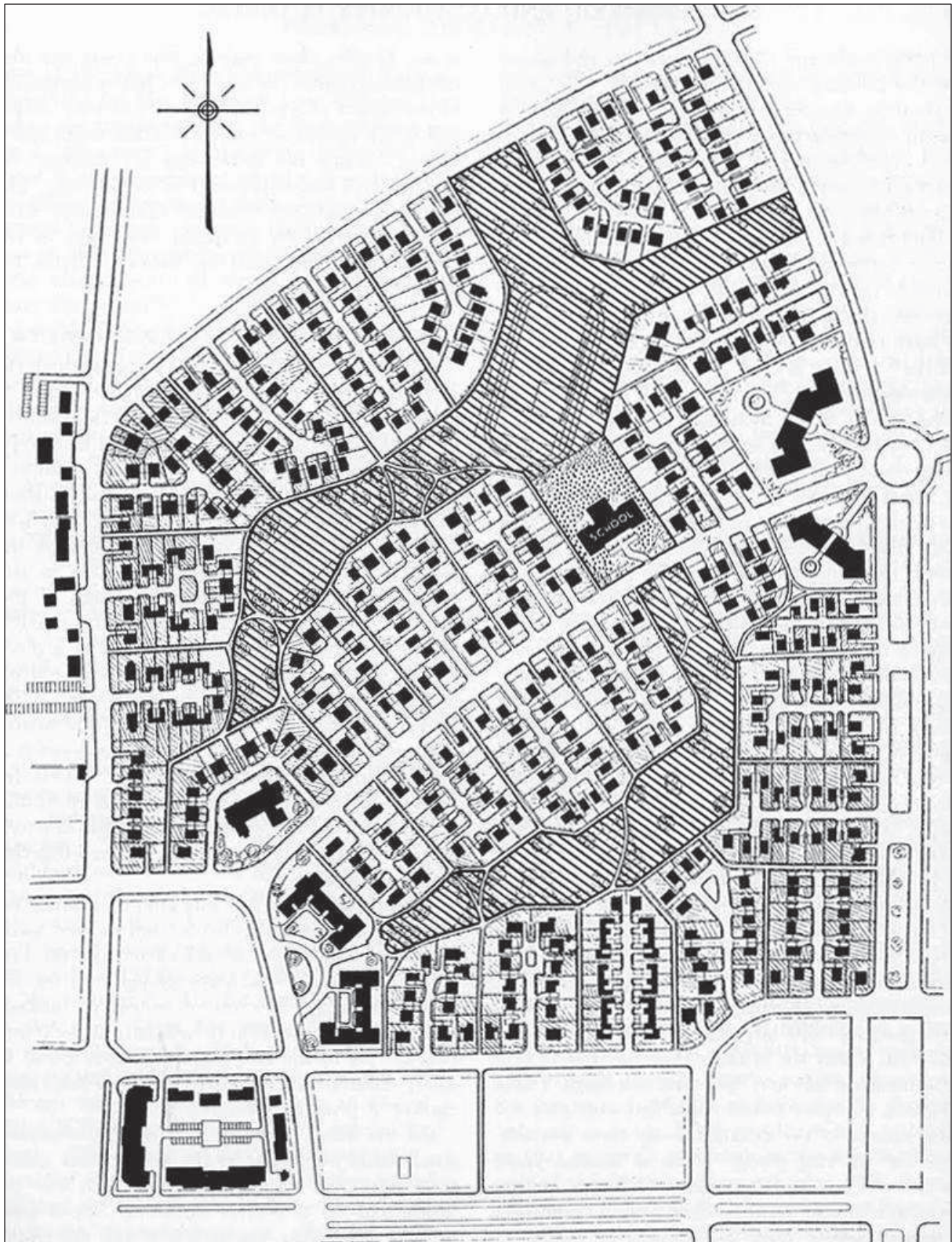
Fig. 4 : Radburn, étude préliminaire de deux super-blocks , par Clarence S. Stein & Henry Wright (1929)
