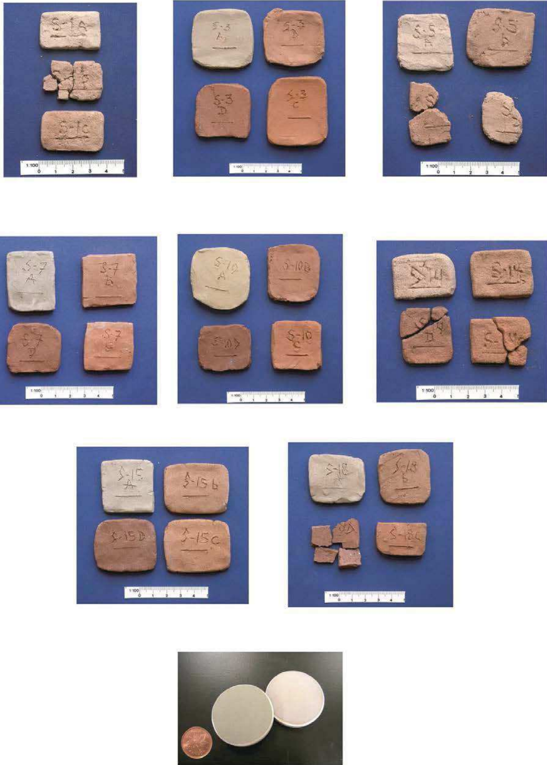
Fig. 335. Argilos. Briquettes et pastilles réalisées à partir des argiles prélevées sur le site.
