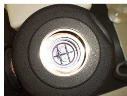
FIGURE 3.3 – Intérieur du four du calorimètre TA-instrument mDSC-2920. Le creuset de mesure est hermétiquement fermé puis percé.
