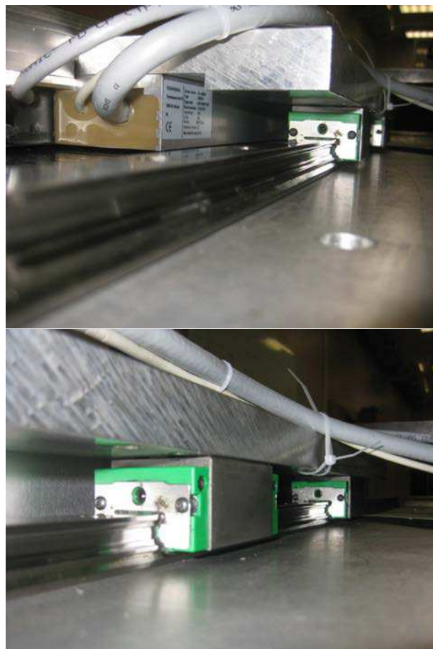
FIGURE 2.16 – Détails du guidage du moteur de charge
