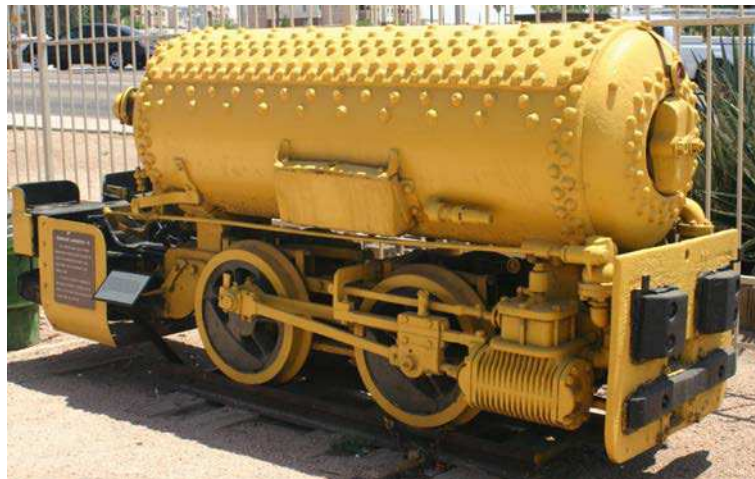
FIGURE 1.1 – Une locomotive à air comprimé fabriquée par la société américaine Porter dans les années 1920 et employée dans des mines de charbon en Pennsylvanie jusqu'en aout 1985 !
