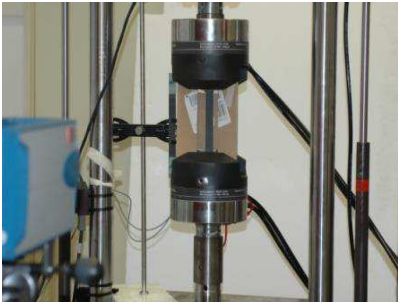
Figure 3.7 : Dispositif expérimental pour les essais de suivi thermique
