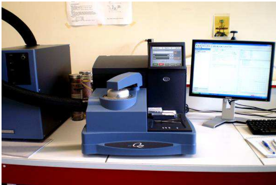
Figure 2.9 : Machine de calorimétrie différentielle à balayage (DSC) pour la détermination de la chaleur spécifique de la résine époxy
