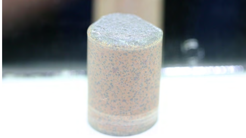
Figure V.12. Photographie d'un échantillon massif carotté avec additifs (ajoutés par voie liquide au planétaire) frittés à 950°C pendant 6 heures.
