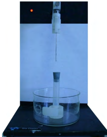
Figure II.22. Photographie du système d'enduction dans la procédure modifiée.
