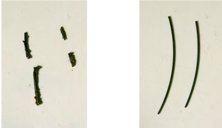
Figure V.7. Fils d'Inconel 600® traités à 950°C pendant 4 heures en contact (à gauche) et sans contact (à droite) avec la poudre PZT.
