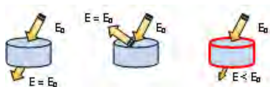
Figure V.38. Les différents types d'interactions avec les micro-ondes : de gauche à droite, transparent, opaque et absorbant.
