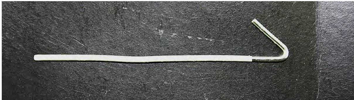
Figure V.33. Fil d'argent après le dépôt d'une couche de PZT avec additifs et consolidation à 750^\circ\text{C} pendant 2 heures.
