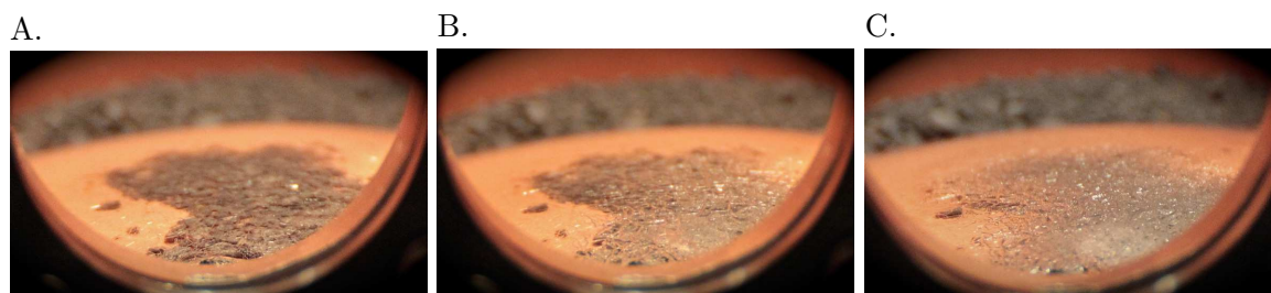
FIGURE 5.30 – Evolution d’un slab condensé sur des minéraux soumis à du rayonnement thermique incident par le haut du montage. Les grains minéraux absorbent le rayonnement transmis à travers la glace transparente, leur émission de chaleur sublime le slab par l’intérieur en le rendant plus diffusant.
