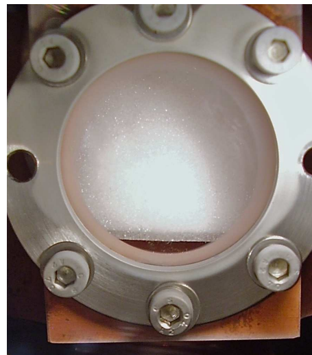
FIGURE 6.2 – Vue latérale de l'échantillon basculé vers le bord opposé. La couche millimétrique de glace compactée par métamorphisme est visible dans la partie la plus basse du bloc de CO 2 .
