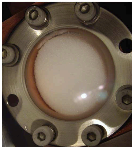
FIGURE 6.1 – Côté où l'échantillon s'encastre dans une niche latérale suite à un basculement. Le bloc de neige, érodable, adopte rapidement la forme de la niche par frottement et sublimation par apport de chaleur des parois.
