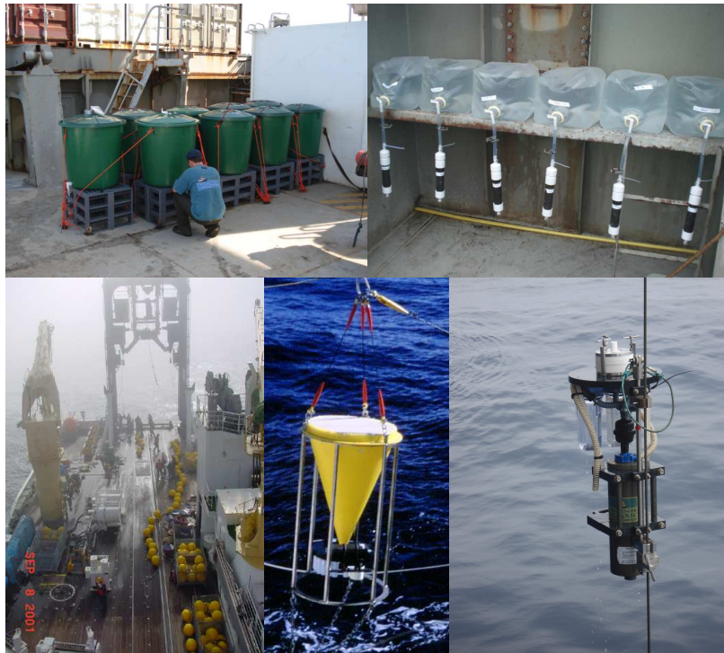
Figure 6 : Pré-concentration des isotopes du radium dans des cuves de 300 L au large de l'Indonésie (projet INDOMIX) ; Filtration d'eau de mer sur des cartouches d'acrylique imprégnées de manganèse (projet INDOMIX) ; Travail sur le pont du navire japonais RV Mirai (JPAC) ; Déploiement d'un piège à particules McLane ® dans le Pacifique Nord ; Déploiement d'une pompe in situ Challenger ®, filtre 142 mm au large des Kerguelen (KEOPS II).
