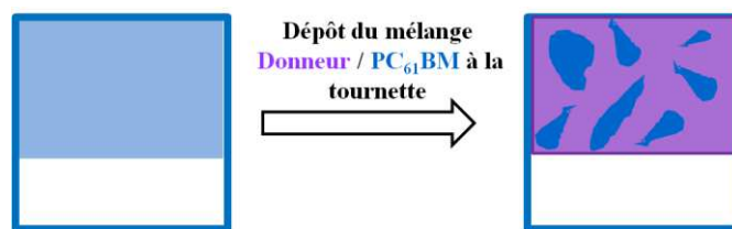
Figure B - 4 : Dépôt de la couche active pour une cellule en réseaux interpénétrés
