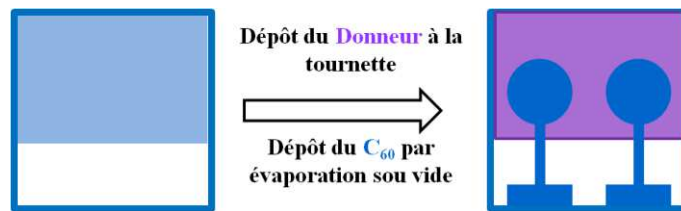
Figure B - 3 : Dépôt de la couche active pour une cellule bicouche.
