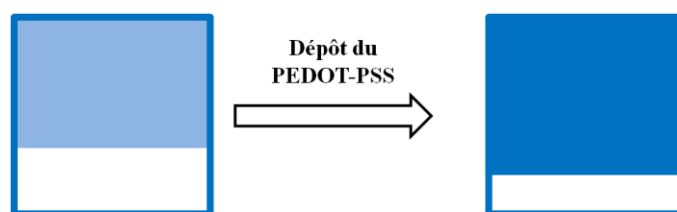
Figure B - 2 : Dépôt du PEDOT-PSS à la tournette (RPM = 5000 tours)
