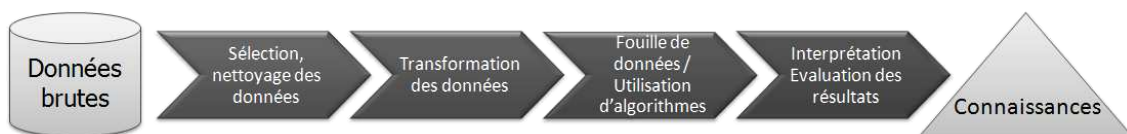
FIGURE 2.4 – Processus d'Extraction de Connaissances à partir de Données, adapté de [FPSS96]
