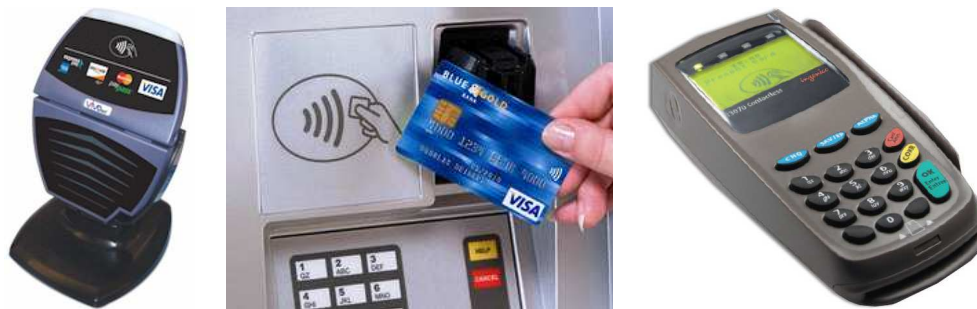
FIGURE 3.7 – Exemples de lecteurs et terminaux sans contact
