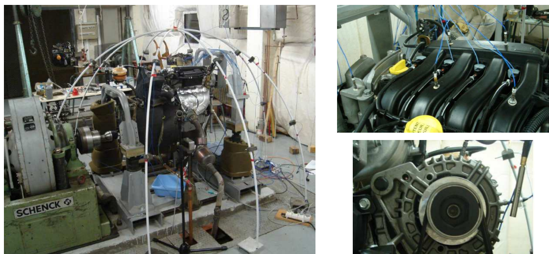
FIGURE 1.4 – A gauche : dôme de mesure autour du moteur essence étudié. A droite : exemples de capteurs de référence : en haut : accéléromètres collecteur d'admission. En bas : microphone courroie et accéléromètres alternateur.
