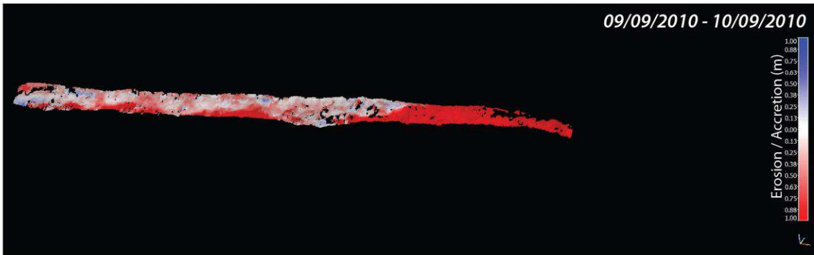
Cartes des changements topographiques significatifs (> c.i. in M3C2) sur la berge des mesures journalières
