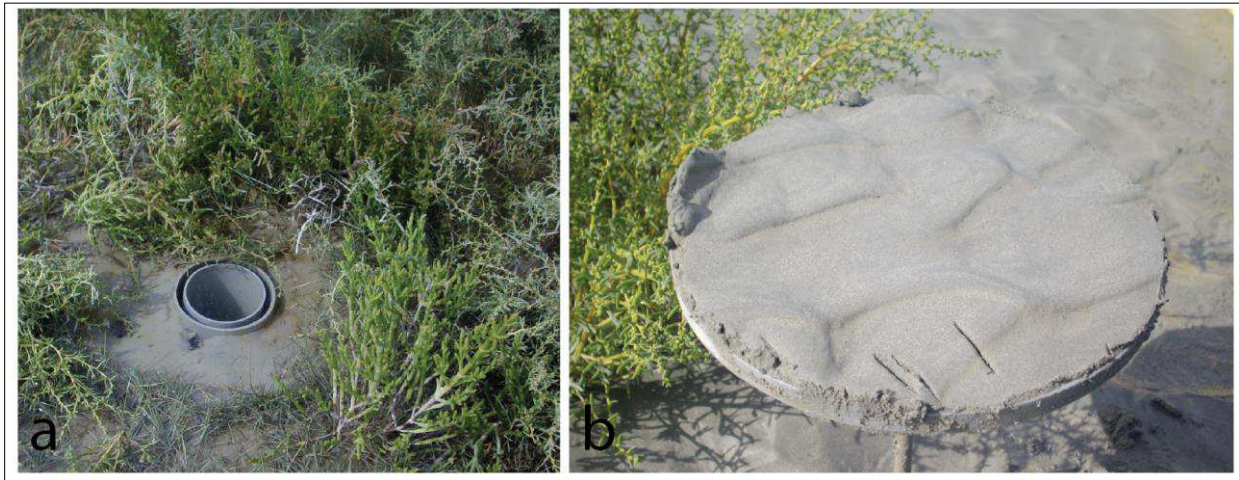
Figure 1.40 : a. Cylindre en PVC installé à la surface du sol dans une zone de prés-salés végétalisé en Baie du MSM. b. Disque à surface définie mesure la sédimentation ( \text{g/m}^2 ) grâce à la quantité de sédiment récupéré et séché.
