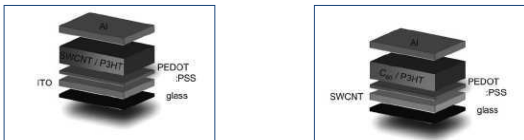
Figure 5-14 : Prototypes d’OPVCs à base de NTC : à gauche SWNT utilisé comme électrode dans les OPVC ayant comme électrode verre/ITO/ PEDOT : PSS/SWNT : P3HT/Al. A droite CNT utilisé comme électrode semi-transparente dans la configuration verre/SWNT/ PEDOT : PSS/P3HT : PCBM/ Al d’après Sgoba et Guldi 221
