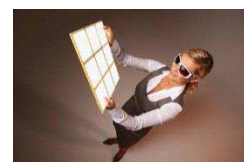
Module OLED LEDON , 30 lm/W, épaisseur 5 mm - Prototype Juin 2011
