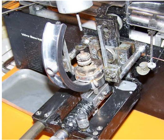
Fig. II.4 : Scie à fil. Le cristal à découper est collé sur la tête goniométrique, la même ayant servi pour l'orienter.
