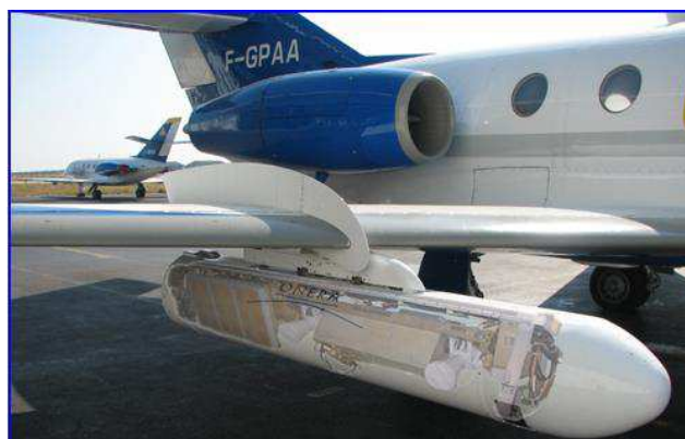
Figure 3.2 - Image du montage du pod SETHI situé sous l'aile droite du Falcon 20. Les capteurs radar sont intégrés dans ces pods.
