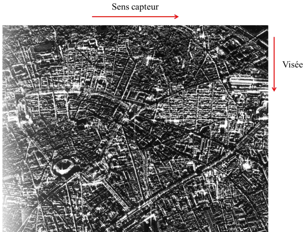
Figure 3.3 - Exemple d'une image THR non géoréférencée acquise par le capteur SETHI à partir d'une trajectoire circulaire aéroportée autour des arènes de Nîmes. L'image représente une zone d'environ 2km par 2km.
