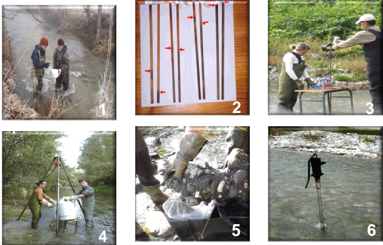
Figure II-4 : Illustration de quelques techniques utilisées pour l'étude comparée de terrain. Mesure de la conductivité hydraulique (1), pénétrométrie (2), lecture des limites anoxiques sur les bâtons (3 : photos P. Marmonier), carottage cryogénique (4), carotte cryogénique avant découpe en strates (5) et système Bou Rouch (6).
