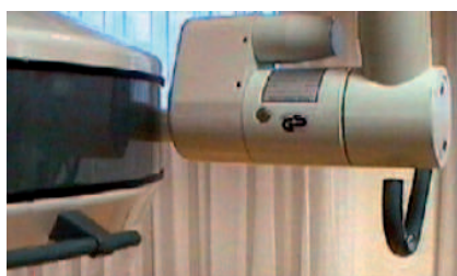
(a) Agrandissement sur la motorisation du LightPilot (source : Service-manual Chromophare C950G)
