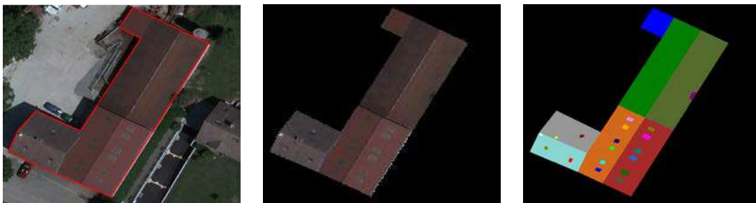
FIGURE 4.7 – Exemple de toiture et sa vérité terrain correspondante. (de gauche à droite : toiture avec l'empreinte au sol, toiture à segmenter et la vérité terrain correspondante).
