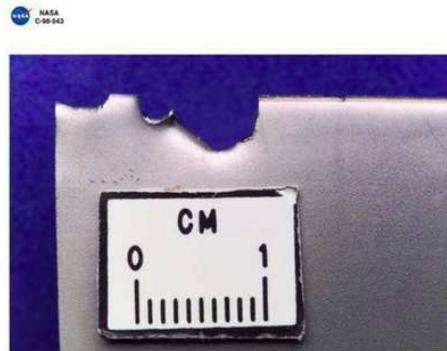
FIGURE 4.4 – Aube endommagée par du pompage
