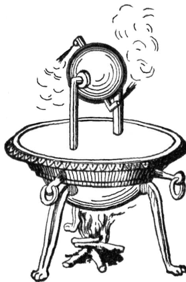
FIGURE 3 – L'éolipyle de Héron d'Alexandrie
