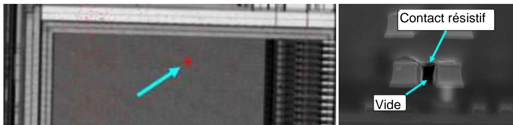
Figure I-15 : Cartographie SDL superposée à l'image optique du circuit. La zone sensible est pointée par la flèche (à gauche). Image MEB du défaut après coupe FIB (à droite). Crédits [HaWi09].
