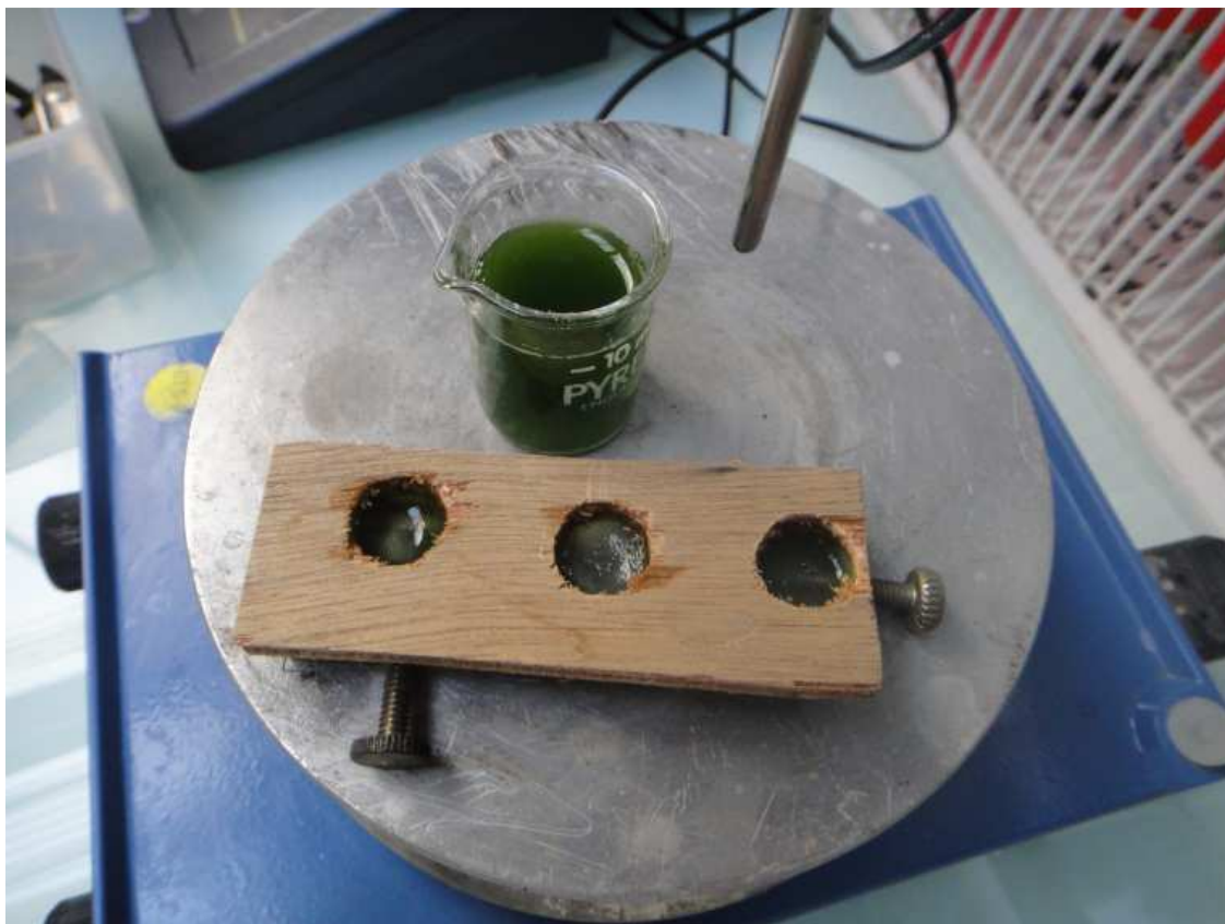
Figure 45 : solution d'agarose contenant les microalgues et déposée dans les moules
