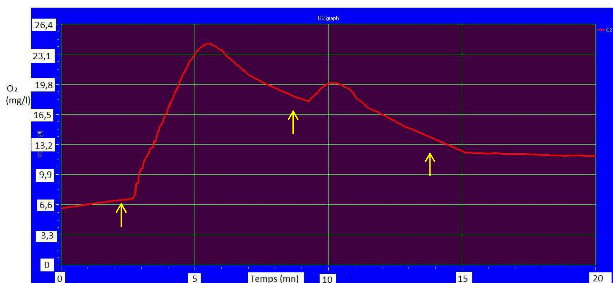
Figure 50 : [O_2] = f(t) après 3 injections successives de 0,5 % d' H_2O_2 sur bille d'alginate immobilisée au contact d'une électrode de Clark
