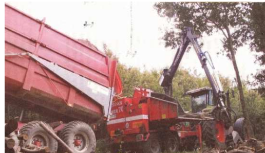
La déchiqueteuse à grappin bras articulé permettant de saisir le bois pour le mettre dans la machine
