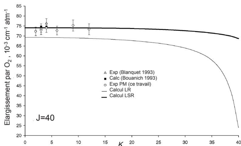
FIGURE 2.5: Dépendance en  $K$  du coefficient d'élargissement avec le dioxygène. Comparaison entre expériences et modèles théoriques [44].
