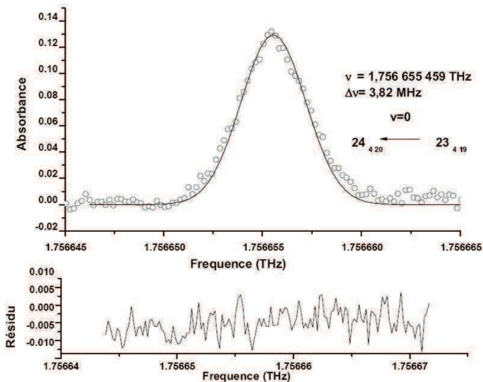
FIGURE 1.14: Transition de rotation pure dans l'état vibrationnel fondamental du formaldéhyde enregistrée sur le spectromètre à onde continue THz par photométrie à 1.7 THz à une pression de  $80\mu$ bar et dans une cellule de 60 cm de trajet optique. La courbe noire représente la modélisation de la transition, les ronds vides représentent les points expérimentaux.
