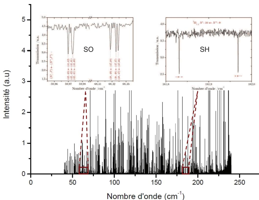
FIGURE 4.11: Spectre obtenu sur la ligne AILES par décharge DC (980 W) dans un flux d'un mélange  $\text{H}_2\text{S}$ , He,  $\text{H}_2$ , air. En encart, un agrandissement sur les transitions des radicaux SO et SH. Des raies du précurseur  $\text{H}_2\text{S}$  et de l'eau sont également présentes sur le spectre. Résolution  $0,00102 \text{ cm}^{-1}$  (30 MHz), spectre résultant de l'accumulation de 98 spectres.
