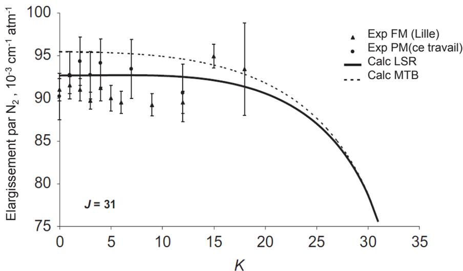
FIGURE 2.6: Coefficients d'élargissements par le diazote déterminés expérimentalement au PhLam à Lille (triangles) et au LPCA à Dunkerque (ronds) tracés en fonction du nombre quantique  $K$  pour  $J=31$ , comparées à deux modèles théoriques [45].
