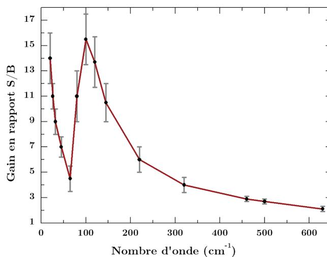
FIGURE 4.1: Rapport signal-sur-bruit obtenu avec rayonnement synchrotron divisé par celui obtenu en source interne (globar), valeurs obtenues pour une résolution (maximale) de l'interféromètre ( $30 \text{ MHz} \cdot 0.00102 \text{ cm}^{-1}$ ). D'après [45]
