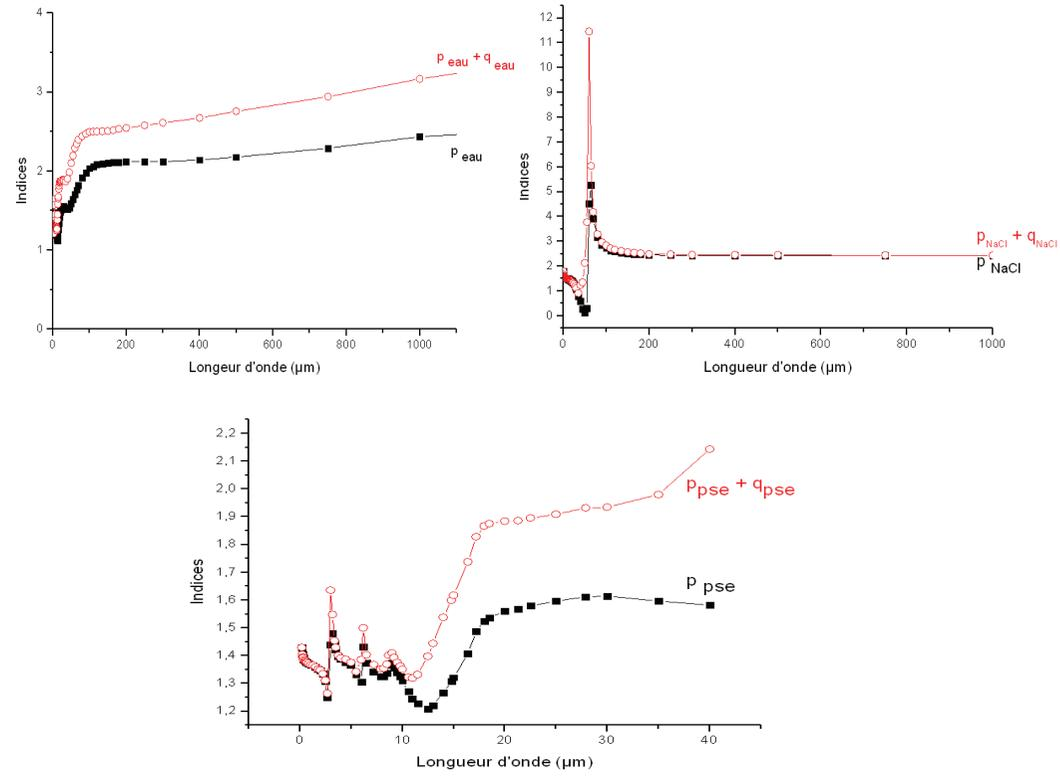
FIGURE 5.16: Indices réels et imaginaires de l'eau, de NaCl et de particules solubles dans l'eau (pse). En carrés noirs : indices réels  $p$ . En ronds rouge : les sommes de l'indice réel  $p$  et de l'indice imaginaire  $q$ .
