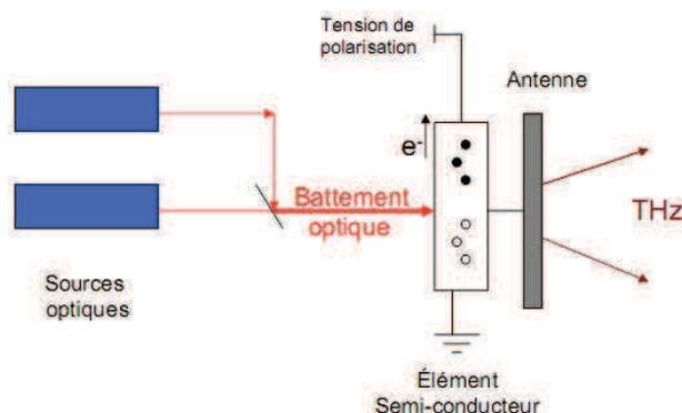
FIGURE 1.4: Schéma de principe de la génération d'ondes THz par technique de photomélangement
