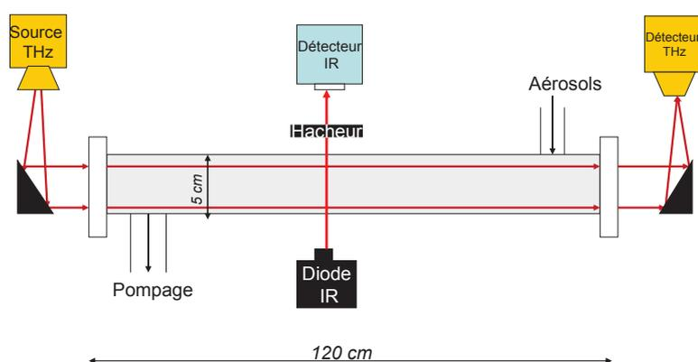
FIGURE 5.13: Schéma du dispositif expérimental permettant la comparaison des pertes entre les ondes THz et proche-IR en présence d'aérosols (vue de dessus).
