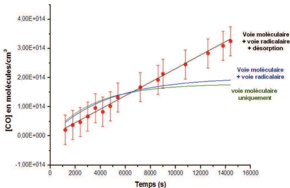
FIGURE 5.10: Influence des réactions prises en compte dans l'élaboration du modèle édifié dans le logiciel Facsimilé<sup>®</sup>. Ajustement en ligne solide, données expérimentales en rond rouges, obtenues pour une expérience menée avec filtre AM 1.5, une pression initiale de  $230\mu\text{bar}$  et  $[\text{H}_2\text{CO}]_0=2,80.10^{14}$  molécules/cm<sup>3</sup>.
