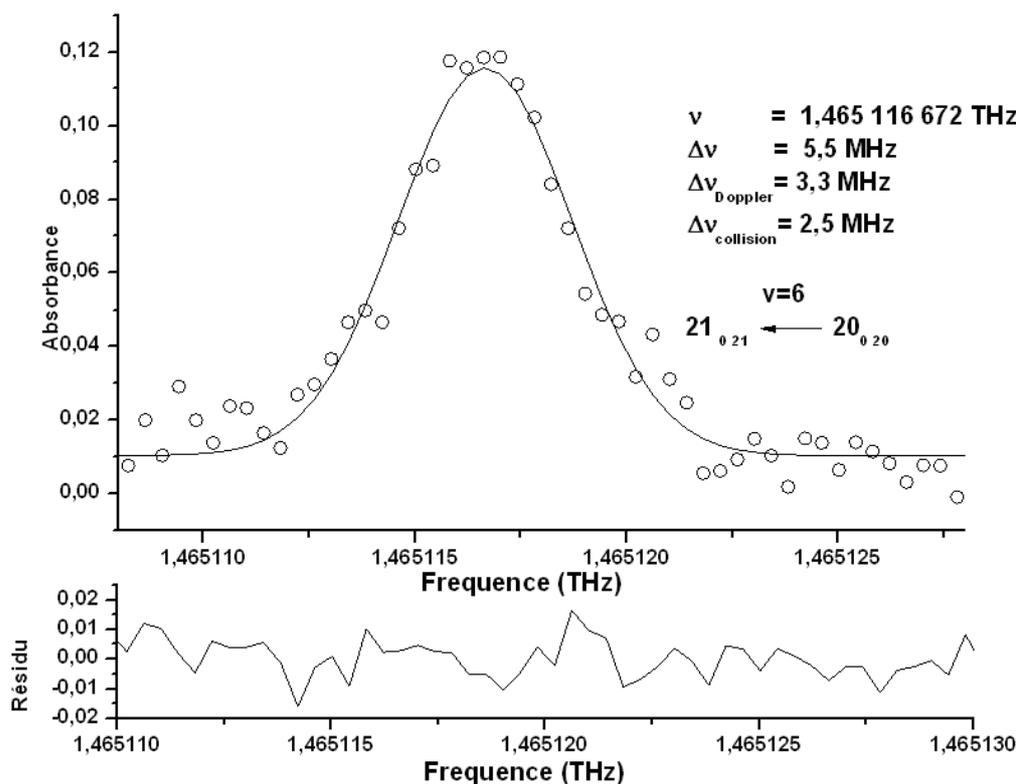
FIGURE 1.16: Transition  $21_{0,21} \leftarrow 20_{0,20}$  de  $\text{H}_2\text{CO}$  dans l'état vibrationnel  ${}^1_6$  rock ( $B_2$ ) enregistré avec le spectromètre THz-photomélangé à 1,465 THz ( $P = 120\ \mu\text{bar}$ ,  $L = 8.8\ \text{m}$ ). La courbe noire représente la modélisation de la transition, les ronds vides représentent les points expérimentaux
