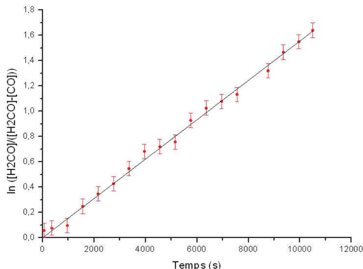
FIGURE 5.7:  $\ln \frac{[H_2CO]_0}{[H_2CO]_0 - [CO]} = f(t)$ , pour une concentration initiale de  $[H_2CO]_0$  mesurée, égale à  $2,84 \cdot 10^{14}$  molécules/cm<sup>3</sup>. En ronds rouges, valeurs obtenues à partir des données fournies par les spectres de CO enregistrés en fonction du temps (Figure 5.6). La photolyse est effectuée avec le filtre AM 0.  $k_m = 1,51 \cdot 10^{-4} \text{s}^{-1}$ .
