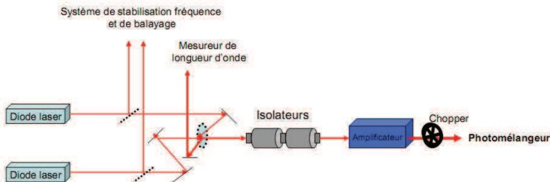
FIGURE 1.6: Détails de la section 1 du banc de spectroscopie
