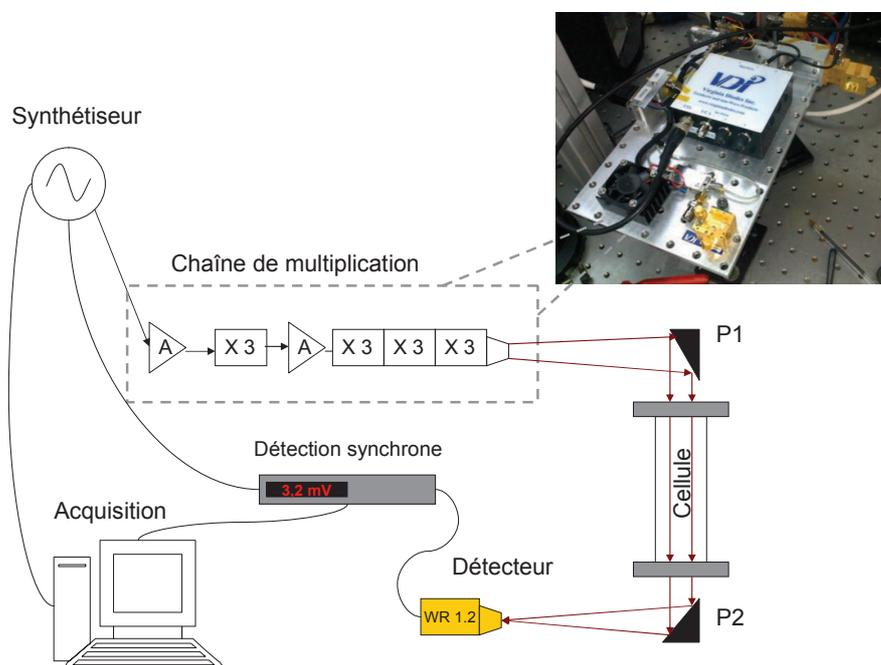
FIGURE 5.3: Schéma du banc de spectroscopie THz par multiplication de fréquence. A désigne les amplificateurs de puissance, P1 et P2 sont les miroirs paraboliques de 152 mm de focale. La zone encadrée par les pointillés gris représente la source THz par multiplication de fréquence commercialisée par VDI dont une photographie est présentée en encart.
