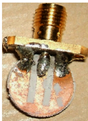
FIG. 3.7 – Capteur microonde composé d'une ligne coplanaire avec masse, poudre de \text{SnO}_2 , et connecteur SMA.
