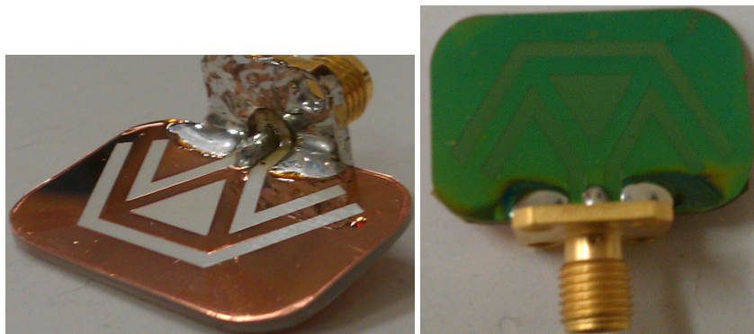
FIG. 3.9 – Capteur équipé d'un connecteur SMA, sans et avec dépôt.
