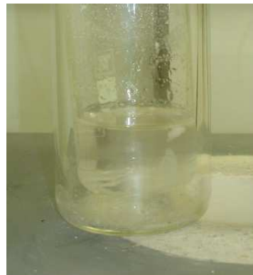
FIGURE 2.2: A gauche : sel LiF à l'état solide massif (photographie fournie par Véronique Ghetta, LPSC), à droite : sel fondu (FLi-NaF-KF) à 500°C (photographie fournie par Sylvie Delpech, IPNO)
