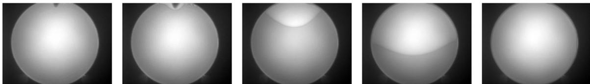
Figure 1 - 20: De gauche à droite, visualisation par camera Infra-Rouge de la propagation de l'onde de collage dans le cas d'un collage  $\text{SiO}_2/\text{SiO}_2$  (substrats Si 200 mm). L'onde est initiée sur le bord supérieur des plaques superposées et se propage en quelques secondes jusqu'à l'autre extrémité du wafer 200 mm.
