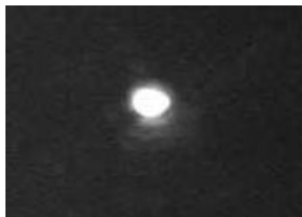
Figure III- 14: Intensité de la lumière à la sortie de la structure hybride, pour un guide de largeur de diffusion de 4\mu\text{m} , et une couche magnéto-optique d'épaisseur 2.6\mu\text{m} ( \lambda = 1550\text{nm} ).
