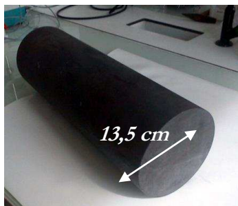
Figure 3-2: Photographie du rondin de graphite utilisé pour la préparation des échantillons
