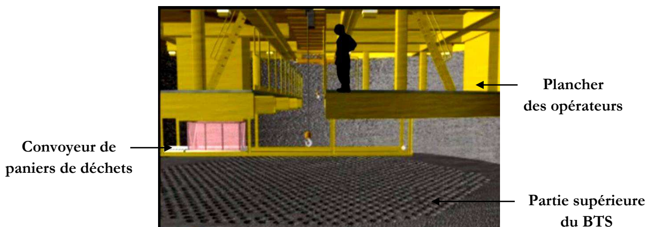
Figure 1-10: Partie inférieure de la plateforme de démantèlement [EDF_Vidéo]
