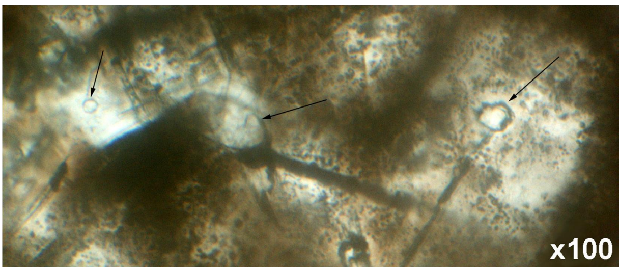
Figure VII-8. Inclusions de fluides dans un pyroxène (en haut et au centre) et dans la mésostase (en bas).
