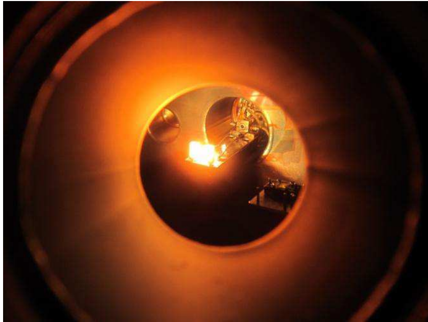
FIG. 5.2: Monocristal de W(110) pendant le « flash », chauffé à 2000^{\circ}\text{C} , lors du processus de traitement, au sein de la chambre de préparation de la ligne.
