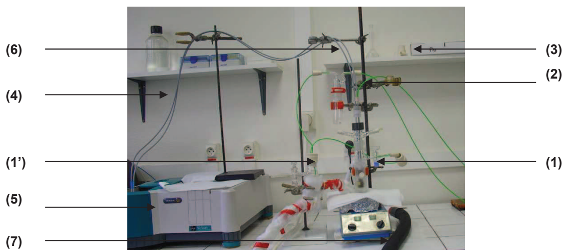
Photo P.2 : Dispositif utilisé pour enregistrer des spectres UV-visible à basse température avec la fibre optique.
