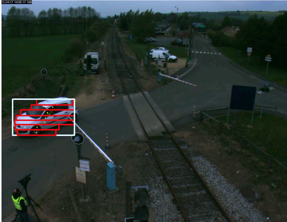
FIGURE 4.2 – Segmentation d'un objet en mouvement par clustering du flot optique.
