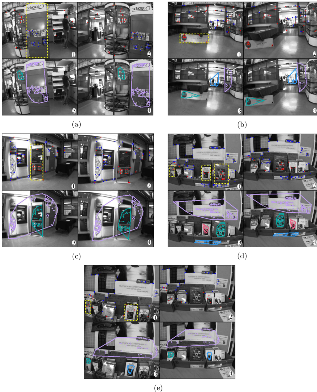
FIGURE 3.11 – Expérience « Hall » : Détection de structures sur cinq cas de reconnaissance de lieu. Vues 1 et 3 : image courante. Vues 2 et 4 : image similaire. Les points 3D sont affichés sur les vues 1 et 2 en bleu pour les points cohérents avec le calcul de pose, en rouge pour les points incohérents. Les vues 3 et 4 donnent les différentes homographies détectées dans les deux vues.
