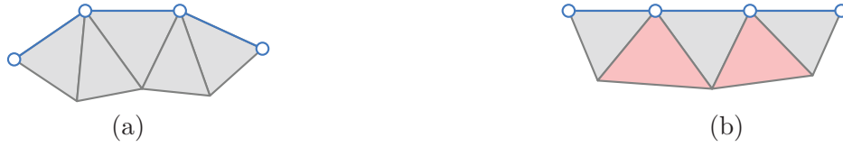
FIGURE 3.26 – Illustration de l'impossibilité de respecter strictement toutes les contraintes : (a) On ne peut déplier la ligne bleue sans altérer la forme des triangles, (b) une possible mise à plat de la ligne bleue cause la déformation des triangles rosés.
