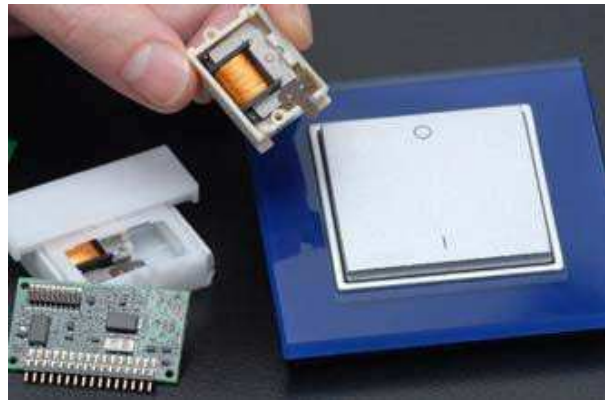
Figure I.14: Interrupteurs à convertisseurs électromagnétiques – EnOcean
