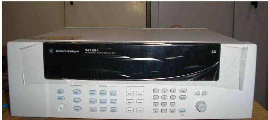
Figure 2.11. Centrale d'acquisition
