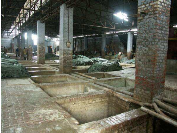
Bacs pour la trempe et le chaulage des peaux avant le tannage Super Tannery Limited, Jajmau, Kanpur, 4 août 2007
