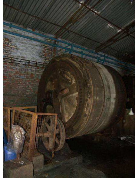
Tonneaux pour le tannage au chrome des peaux Super Tannery Limited, Jajmau, Kanpur, 4 août 2007
