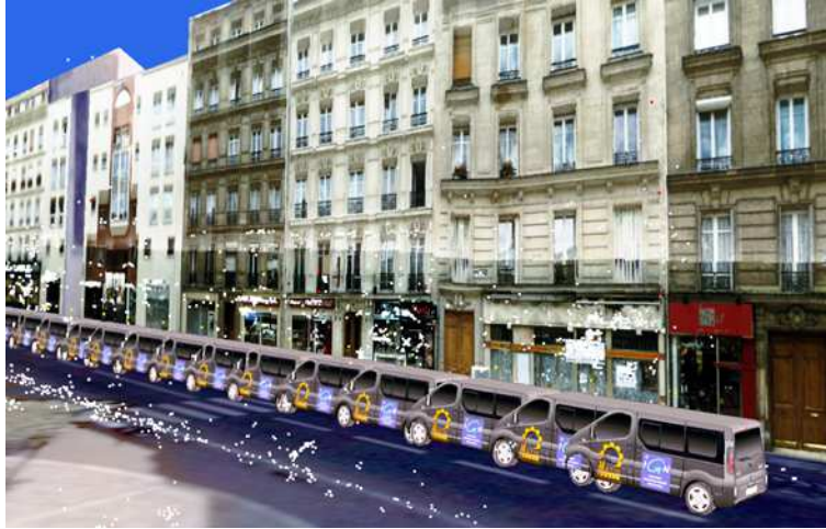
FIGURE 7.2 – Illustration de la compensation par faisceaux. En rouge, les points d'appui, en blanc, les points homologues. Le modèle 3D texturé ne sert que d'illustration.
