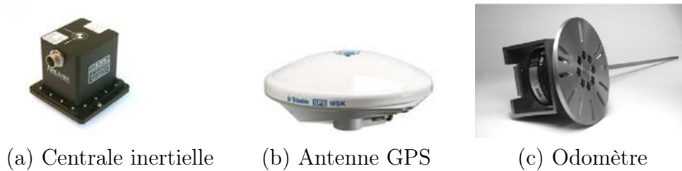
FIGURE 2.10 – Capteurs du système de positionnement PosLV 220.
