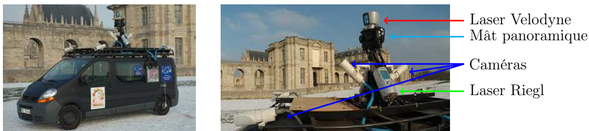
FIGURE 2.2 – Le véhicule Stéréopolis V2 et ses capteurs.
