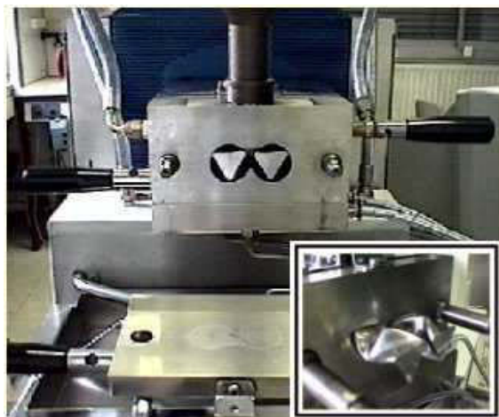
Figure 2.12 : Mélangeur HAAKE Rheomix 600 et schéma de fonctionnement d'un mélangeur interne.
