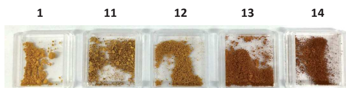
Figure V.23 : Couleurs obtenues sur les matériaux 1 (massique), 11 (79 % tergitol), 12 (80,5 % de tergitol), 13 (83 % de tergitol), 14 (84,5 % de tergitol).
